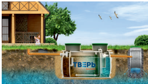
Самотечное отведение в приемный дренажный колодец.
