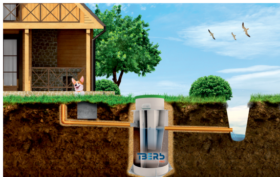
Самотечный отвод воды в канаву
