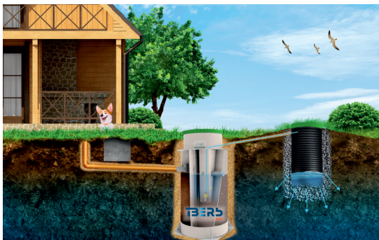
Самотечный отвод воды в дренажный колодец
